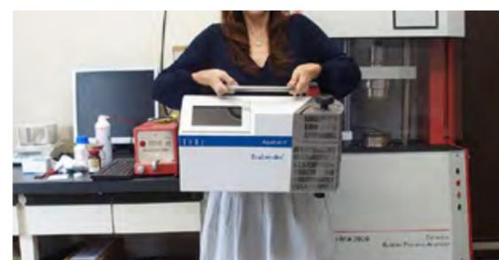
持ち運びができますので研究室だけでなく工場内に持ち込んで測定が可能です。例えばカートに乗せて乾燥機・成形機のすぐそばで測定する事も出来ますので、サンプルを持ち運ぶ途中で吸湿してしまう事も避けられます。
